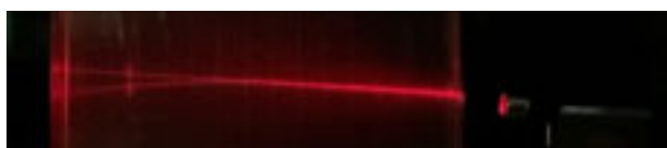
図 1 レーザー光が曲がって見える演示実験 (レーザー光が直進して見える場合の図と合成)
